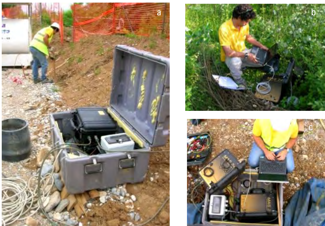
Figura 2.3: Da sinistra in senso orario: a) un tecnico impegnato nel posizionamento del velocimetro V2 presso il cantiere di Vipacco. b) collegamento del computer e c) scarico dati dalla centrale di acquisizione MAS24
