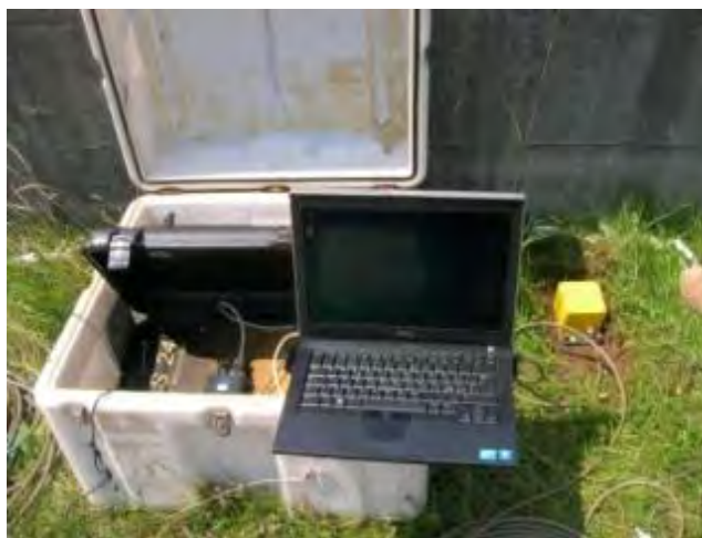
Figura 2.2: Unità di acquisizione mobile installata presso la postazione di arrivo del microtunnel Vipacco
